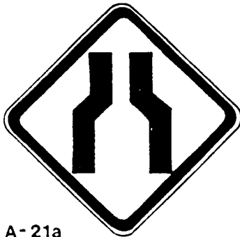
A-21a ESTREITAMENTO DE PISTA AO CENTRO
